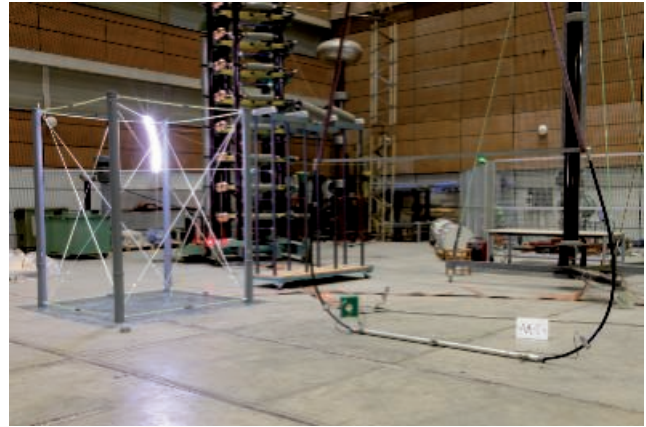
Testopstelling tijdens een piekspanningstest met een equivalente scheidingsafstand ( s_e ) van 75 cm.
