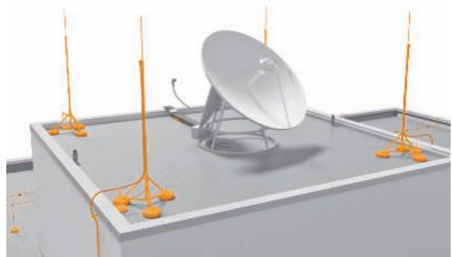
Gescheiden bliksembeveiliging met opvangers
