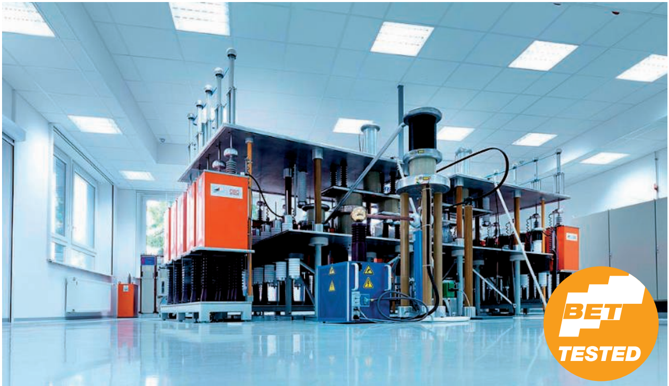
BET-Bliksemstroomgenerator en BET-keurmerk
