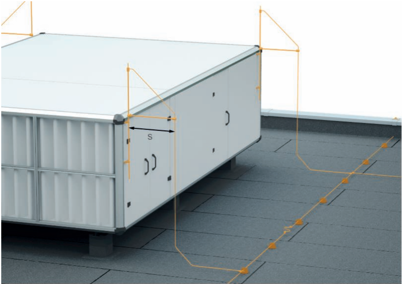
Correct aangehouden scheidingsafstand (s) afleidingsinrichtingen en dakelementen
