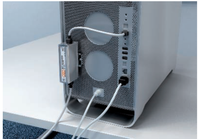
Beveiligingsvoorstel aan eindapparaat Om het beveiligingsniveau laag te houden, gebruikt de overspanningsbeveiliging als PE-verbinding de randaarde van de PC-behuizing.
