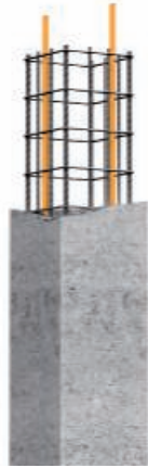
Voorbeeld: gebruik van gewapend betonkolommen/afleidingsinrichting
