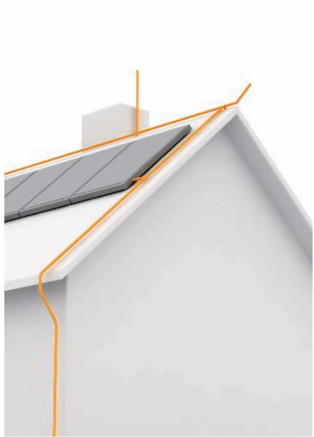
Directe aansluiting van de PV-montageframes aan de bliksembeveiligingsafleiding
